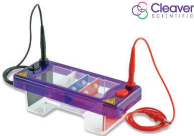
Das MultiSUB mini ist das kleinste Gerät der Serie, designt für kleine und mittlere Probenmengen. Das geringe Puffervolumen von 225 ml erhöht die Effektivität der Analyse.
