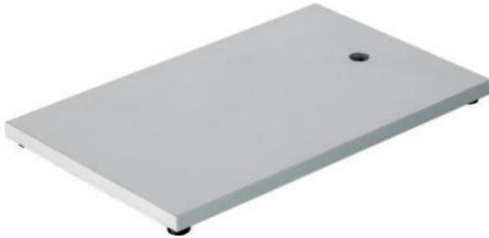
DIN 12892. Stahl, pulverbeschichtet. Stärke 8 mm. Gummifüsse. Mit einer Gewindebohrung M 10 in der Mitte der Stirnseite.
