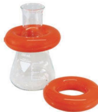
Zur Stabilisierung von Glas- oder Kunststoffgefäßen in Wasser- und Ölbadern. Die Vinyl-beschichtete Oberfläche verhindert das Zerkratzen der Glas-Oberfläche.
