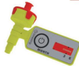
Gelb/rot. Anschlussgewinde UNF 1/4" 28G. Mit Membrane aus PTFE/PP von 1 µm und mit Rückschlagventil aus Silikon. Inklusive aufsteckbarer Wechselanzeige.
