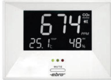
Zur verlässlichen Kontrolle und Beurteilung der Raumluftqualität. Gleichzeitige Messung und Anzeige von Temperatur, CO<sub>2</sub>-Gehalt und Feuchte. Der CO<sub>2</sub>-Gehalt der Luft wird zusätzlich anhand dreier LEDs als gut, mittel oder schlecht angezeigt.
