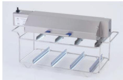
Siebreinigungsmodul aus Edelstahl mit integrierter Dreheinheit zur Reinigung von bis zu 4 Analysensiebe (Ø bis 200/203 mm) im Ultraschallbad. Die Schrägstellung der Analysensiebe im SRH 4/200 gewährleistet einen besseren Reinigungs- und Spüleffekt. Dadurch werden die Analysensiebe schonend und ohne Veränderung der Maschenweite oder Gewebespannung gereinigt. Massgenauigkeit und Kalibrierung der Analysensiebe bleibt zu 100% erhalten.
