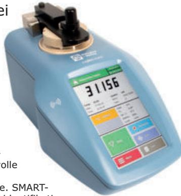
Hochpräzises Messgerät mit Peltier-Temperaturkontrolle für anspruchsvolle Anwendungen in der Lebensmittel-, Getränke- und chemischen Industrie. SMART-Temperaturstabilität, RFID-Benutzeridentifikation und applikationsspezifische, vorprogrammierte Methoden vereinfachen Routineanalysen. Messungen können schnell und zuverlässig in Brix, Brechungsindex (RI) oder bis zu 100 benutzerdefinierten Skalen durchgeführt werden.
