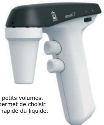
Pour le pipetage précis de grands et petits volumes. Le réglage de la vitesse du moteur permet de choisir entre écoulement libre ou expulsion rapide du liquide.
