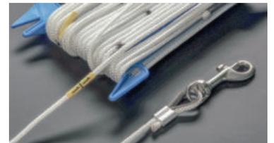
Pour déterminer la visibilité et la transparence de l'eau. Construction solide en plastique fortement résistant. Equipé d'un fil à plomb pour qu'il descende mieux. L'entretoise haute d'env. 15 cm est équipée d'un œillet pour accrocher la corde. La corde est marquée tous les 100 cm de chiffres de 1 à 10, et de traits intermédiaires tous les 50 cm, pour permettre la lecture de la profondeur lorsqu'on descend le disque.
