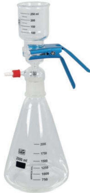
Unité de filtration à usage universel en verre borosilicate de haute qualité. Large spectre d'application pour la filtration avec du papier filtre ou des filtres à membrane (47 mm).
