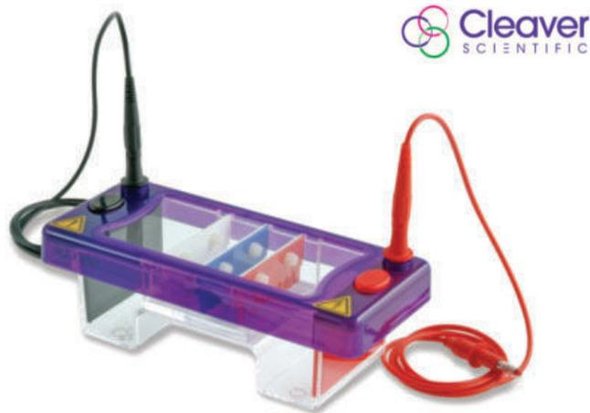
La MultiSUB Mini est la plus petite de la série, conçue pour des petites et moyennes quantités d'échantillons. Le faible volume de solution tampon (225 ml) augmente l'efficacité de l'analyse.
