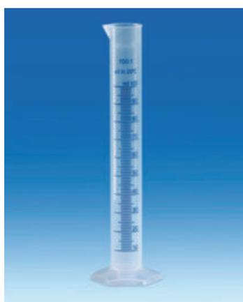
Forme haute. Hautement transparent. Avec graduation bleue en relief, bien lisible et marques circulaires pour les volumes principaux. Calibrée "In". Convient pour contact avec des denrées alimentaires, conformément à la réglementation (UE) n° 10/2011.
